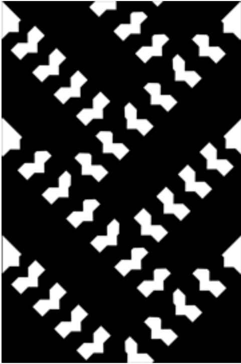
Рис. 7. Направленный рисунок протектора повышенной проходимости
