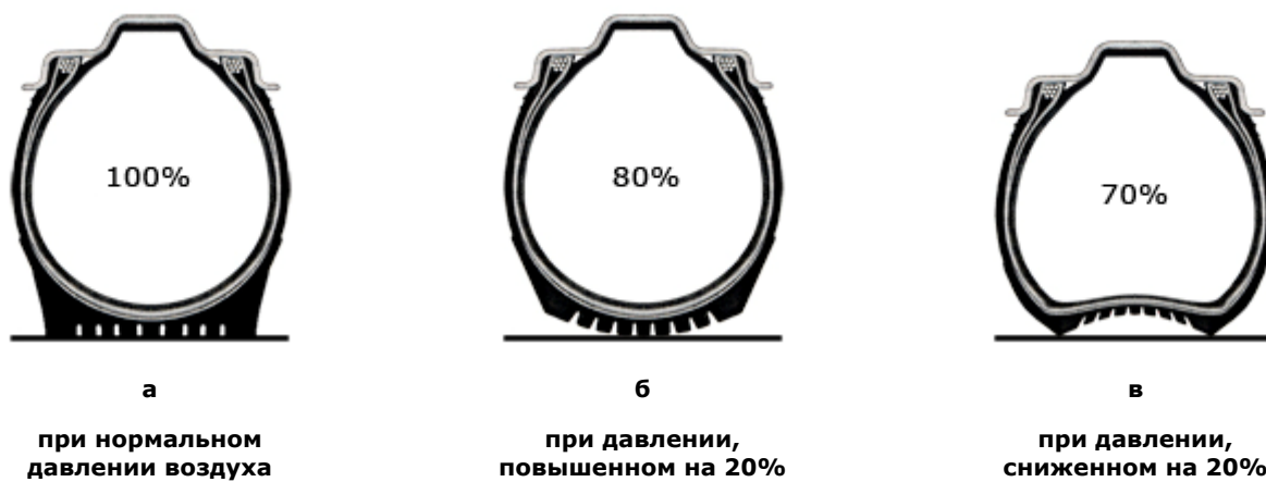
Рис. 14. Вид деформации и использование ресурса шин в %
